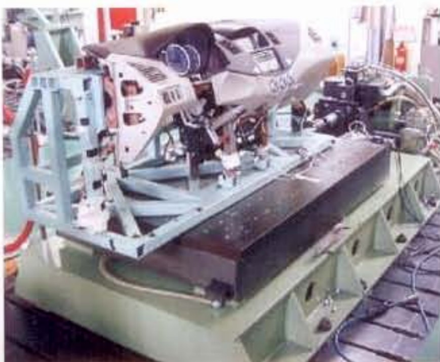
Instrument Panel 振动耐久试验
